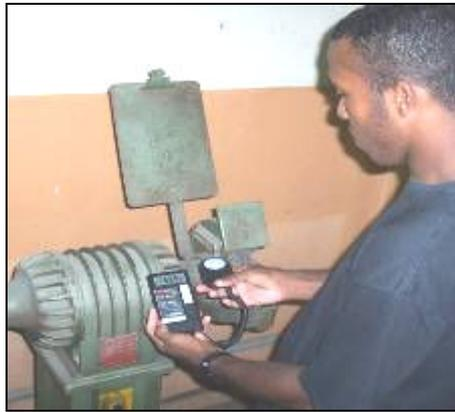
Figura 6 – Medição da luminosidade próxima a esmerilhadeira. Fonte: Própria
