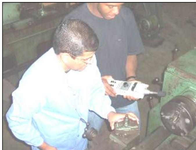
Figura 5: Medição do nível de ruído do torno. Fonte: Própria
