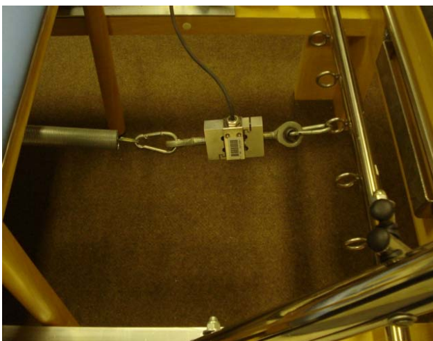
Figura 3: Fixação da célula de carga a mola e ao Reformer.
