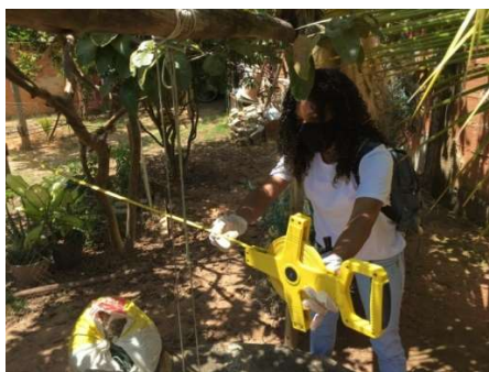
Figura 4 - Medidas das distâncias entre o poço e a fossa séptica, com trena.
