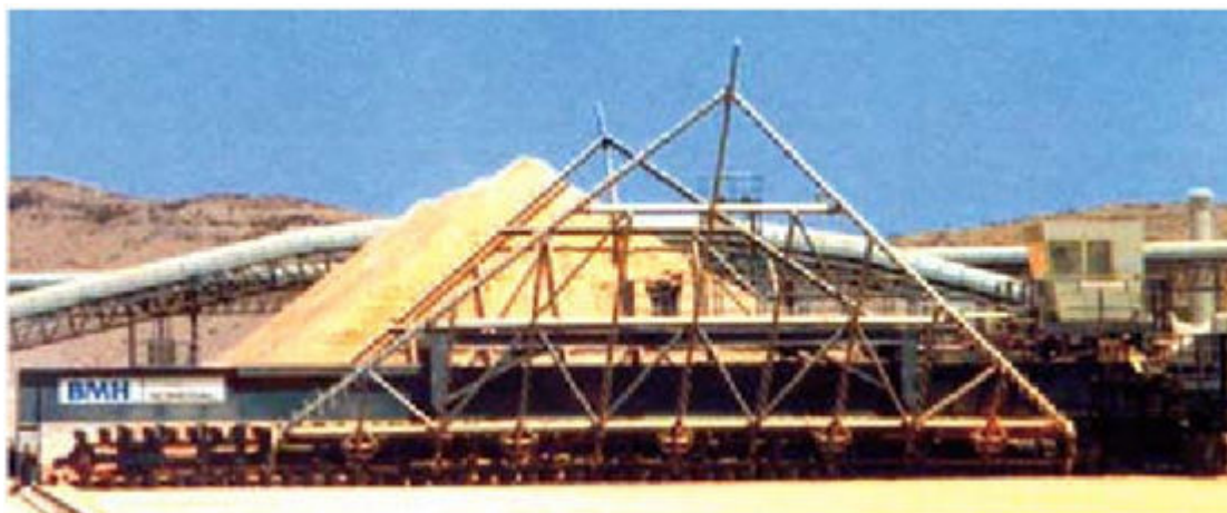
Figura 6: Retomador de arraste em ponte (adaptado de CHAVES E FERREIRA, 2006).
