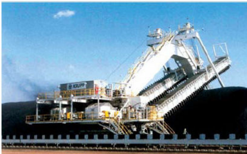
Figura 9: Retomador lateral (adaptado de CHAVES E FERREIRA, 2006).
