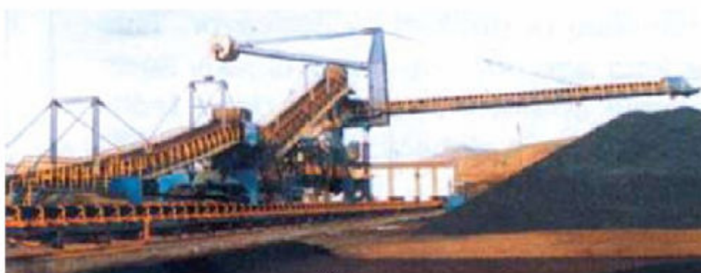
Figura 2: Empilhadeira com lança única e torre giratória (adaptado de CHAVES E FERREIRA, 2006).
