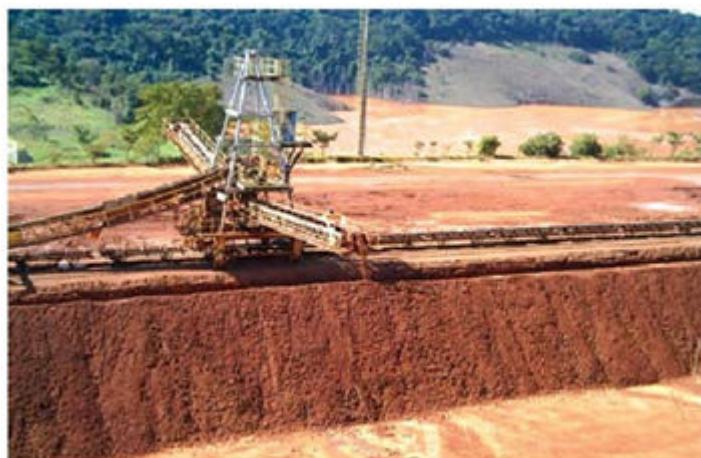
Figura 1: Empilhadeira com lança dupla (adaptado de CHAVES E FERREIRA, 2006).
