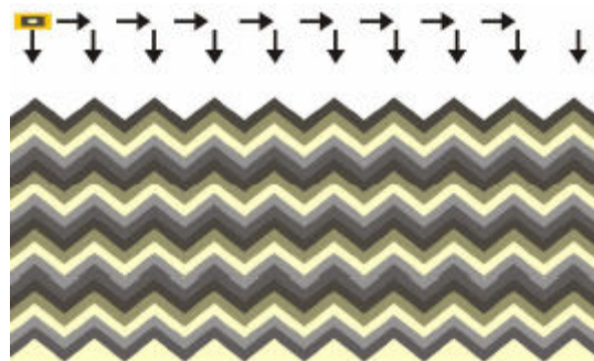
Figura 12: Método windrow (adaptado de FLSMIDTH, 2008).
