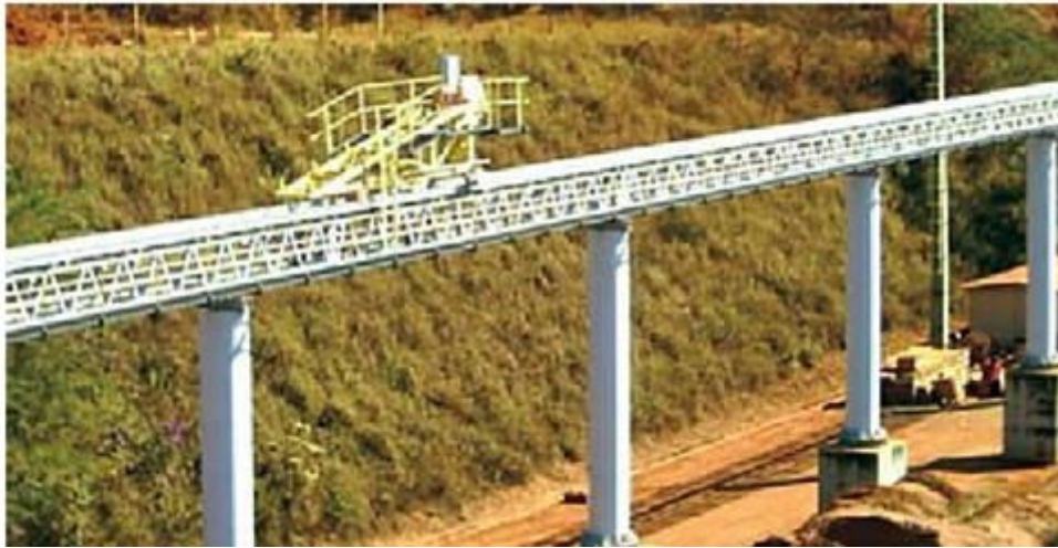
Figura 3: Tripper (adaptado de CHAVES E FERREIRA, 2006).
