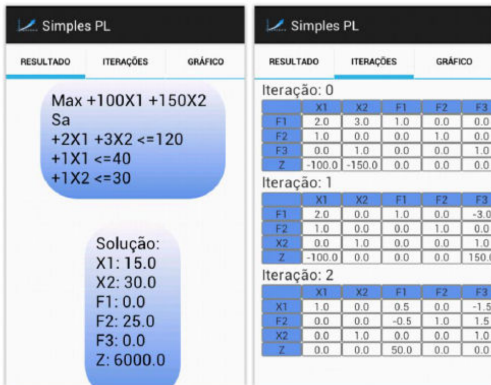
Figura 8– Tela com resultado do problema e onde mostra todas as iterações do problema. Fonte: Própria
