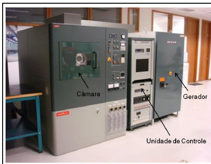
Figura 3 – Máquina de SPS modelo DR. SINTER® - SPS1050. (Tokita, 2000, com adaptações).
