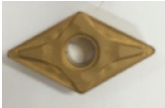
Figura 2: Inserto de Metal Duro tipo DNMG-15-06-08 usado como ferramenta de corte neste trabalho.
