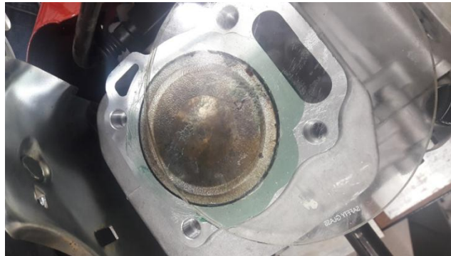
Figura 3: Método para mensurar o volume morto localizado no pistão.
