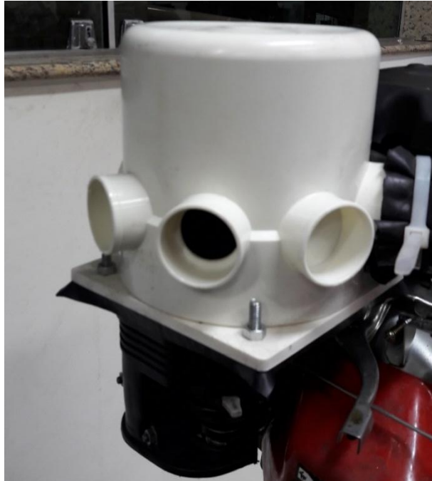
Figura 6: Dispositivo instalado para possibilitar medir a velocidade do ar.
