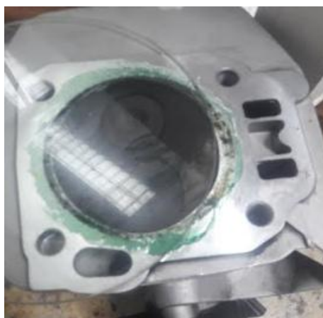
Figura 2: Método de medição do volume morto do cabeçote.
