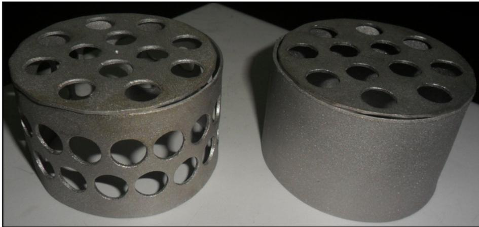
Figura 1 - Gaiolas catódicas com furos e sem furos nas laterais
