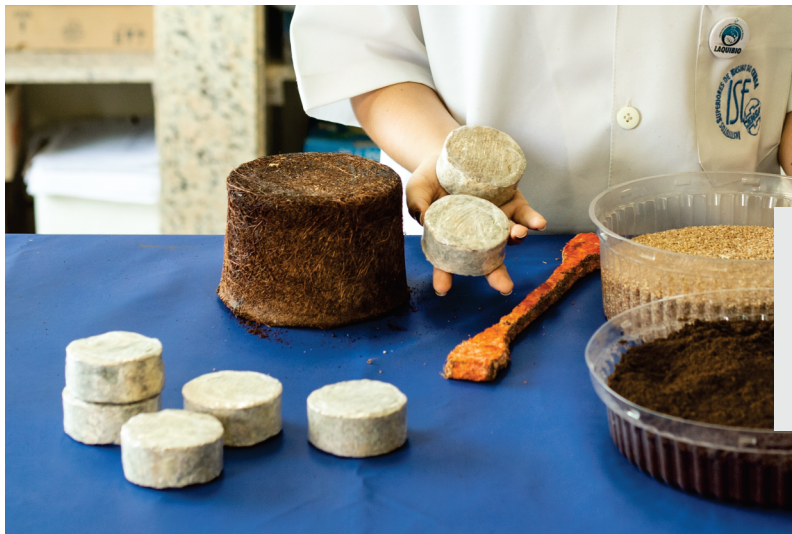
Preparo dos corpos de prova para o estudo das propriedades mecânicas dos micocompósitos
